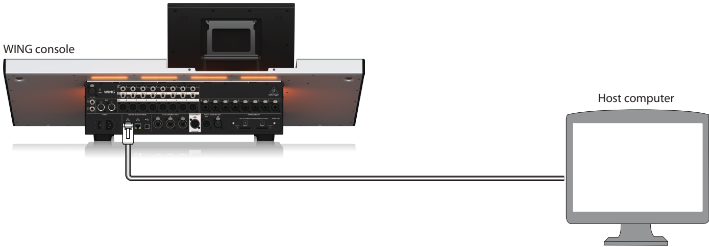
Fig. 1 : Connexion directe entre WING et l'ordinateur hôte
