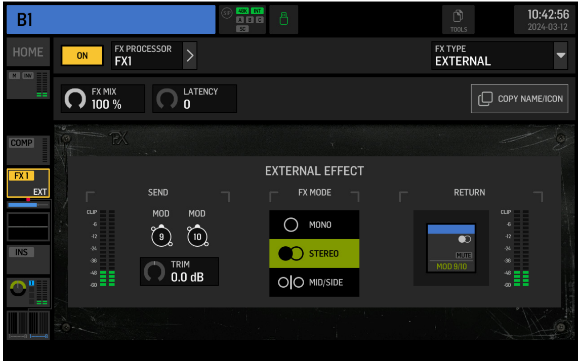
Abb. 7: External als Insert-Punkt auf einem Bus geladen
