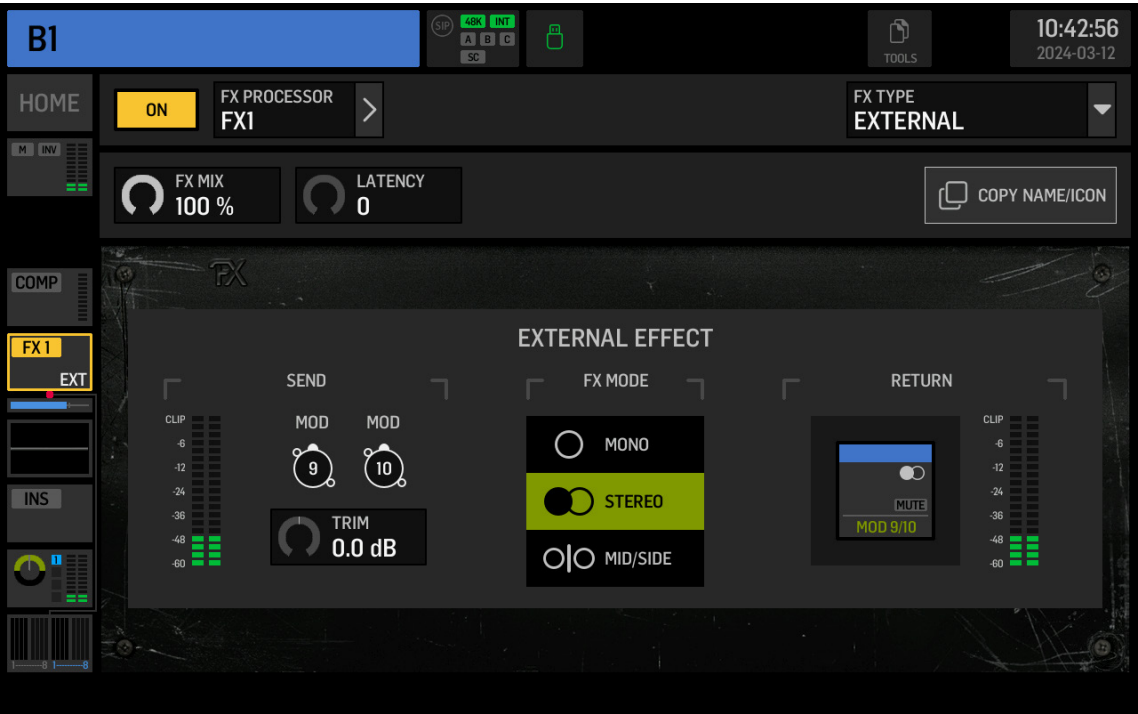
Fig. 7: External załadowany jako punkt wstawienia na magistrali
