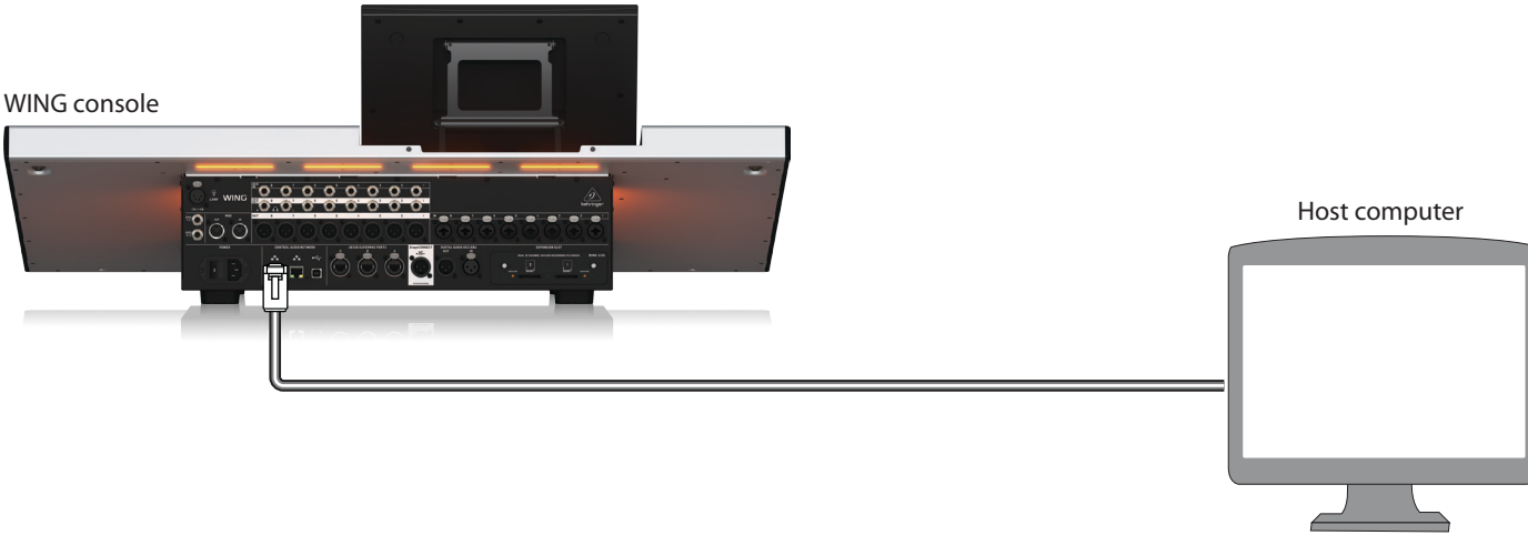
Fig. 1: Direkt anslutning mellan WING och värd-dator
