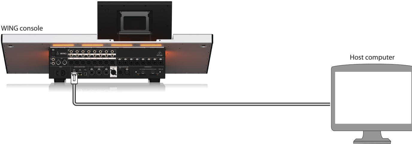
Fig. 1: WING とホストコンピュータとの直接接続
