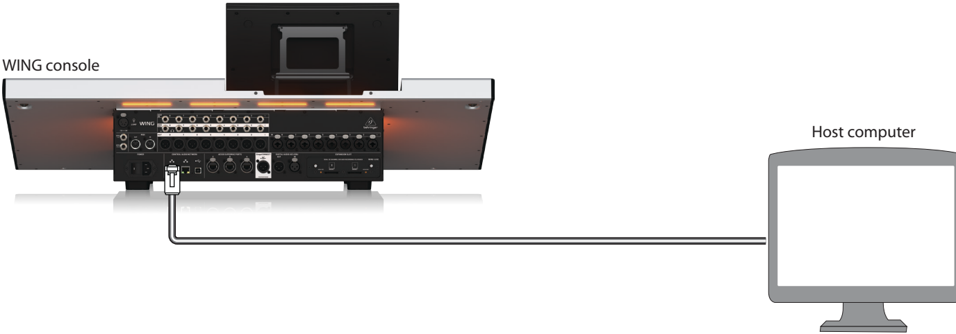
Fig. 1: Connessione diretta tra WING e computer host
