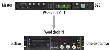
Figura 4-11. Esclavizar otro dispositivo de audio digital a la 828 mediante word clock. Para la fuente de reloj de la 828, elija Interno (o cualquier fuente que no sea Word Clock, ya que no se recomienda la conexión en cadena de Word Clock).
