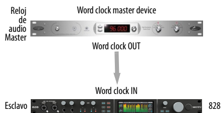
Figura 4-12. Esclavizar la 828 al reloj. Para la fuente de reloj de la 828, elija “Word Clock In”.
