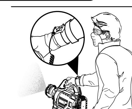
**RETIRE A BATERIA E LIMPE BEM O PULVERIZADOR APÓS CADA UTILIZAÇÃO.**
