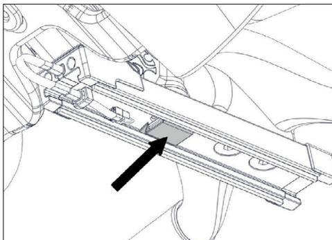
3. Drehen Sie den Daumenhebel an der Lenkerbaugruppe nach links. Schieben Sie die Lenkerbaugruppe auf den horizontalen Lenkerschieber.
