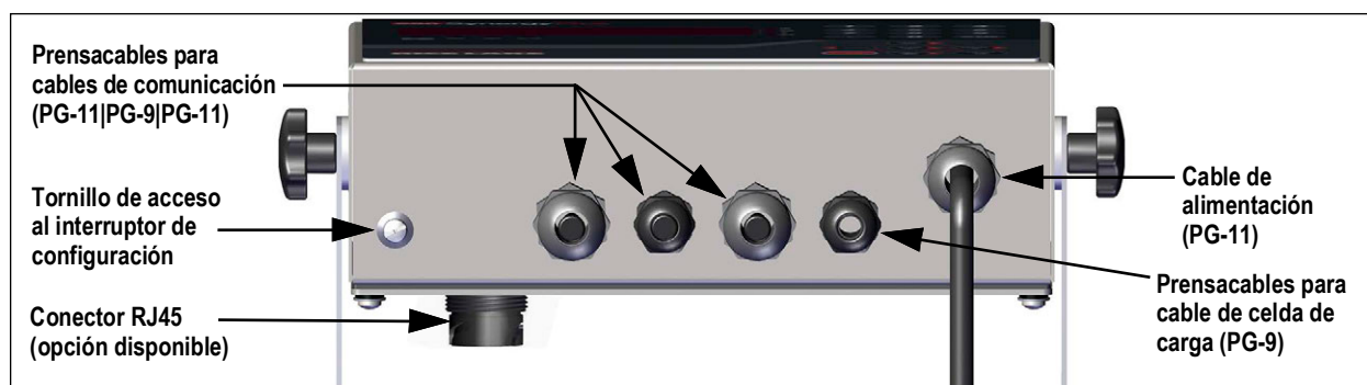
Figura 2-5. Ubicaciones recomendadas para los prensacables
