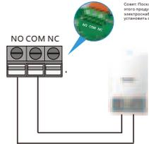
Подключите соединительные устройства в соответствии с рисунком для COM и NO.
