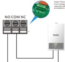
Подключите соединительные устройства в соответствии с рисунком для COM и NO. Совет: Поскольку настенный термостат этого продукта содержит жидкие электролитические конденсаторы, необходимо установить конденсаторы.
