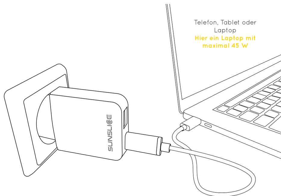
Um den Emperion 45 Mini zu verwenden, stecken Sie ihn einfach in eine Steckdose und verbinden Sie das USB-C- oder USB-A-Kabel mit Ihrem Gerät. Der Ladevorgang startet automatisch.
