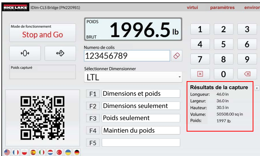
Illustration 5-4. Résultats de la pesée sous forme de données numériques
