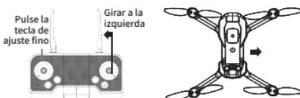
Cuando la aeronave esté planeando y el fuselaje esté volando hacia el lado derecho, pulsa el botón de trimado de entrada y gira el joystick direccional hacia la izquierda para ajustar la aeronave para que vuele suavemente.
