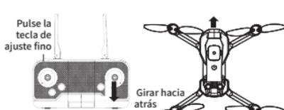
Cuando la aeronave esté planeando y el fuselaje vuele hacia delante, pulsa el botón de trimado de entrada y gira el joystick direccional hacia atrás para afinar la aeronave para que vuele suavemente!
