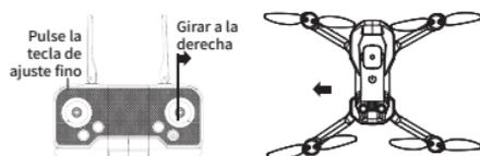
Cuando la aeronave esté planeando y el fuselaje esté volando hacia la izquierda, pulsa el botón Entry Trim y gira el joystick direccional hacia la derecha para ajustar la aeronave y conseguir un vuelo estacionario suave.
