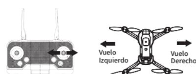
Cuando el joystick derecho se empuja hacia la derecha, la aeronave se desvía hacia la derecha.
