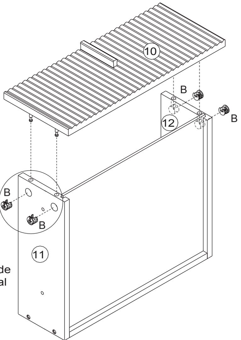
Fije el tablero 10 al cajón, añada el cierre de leva (B) en los orificios del tablero 11,12 y gírelo en el sentido de las agujas del reloj para apretarlo, tal como se muestra.
