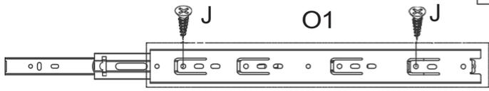
Voltee el tablero 5 hacia atrás, fije la pieza(I) y deslice el riel(O1) también con tornillo(J).
