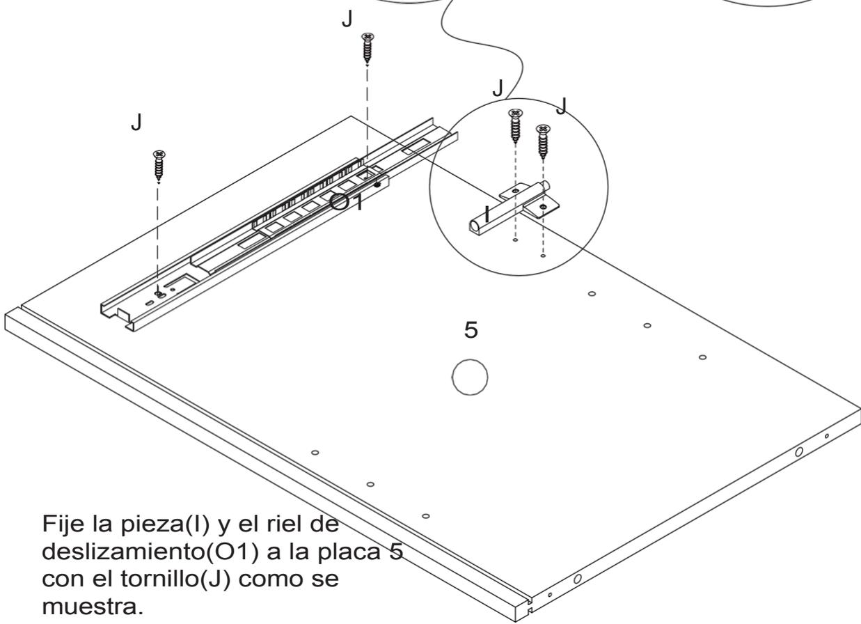
Fije la pieza(I) y el riel de deslizamiento(O1) a la placa 5 con el tornillo(J) como se muestra.
