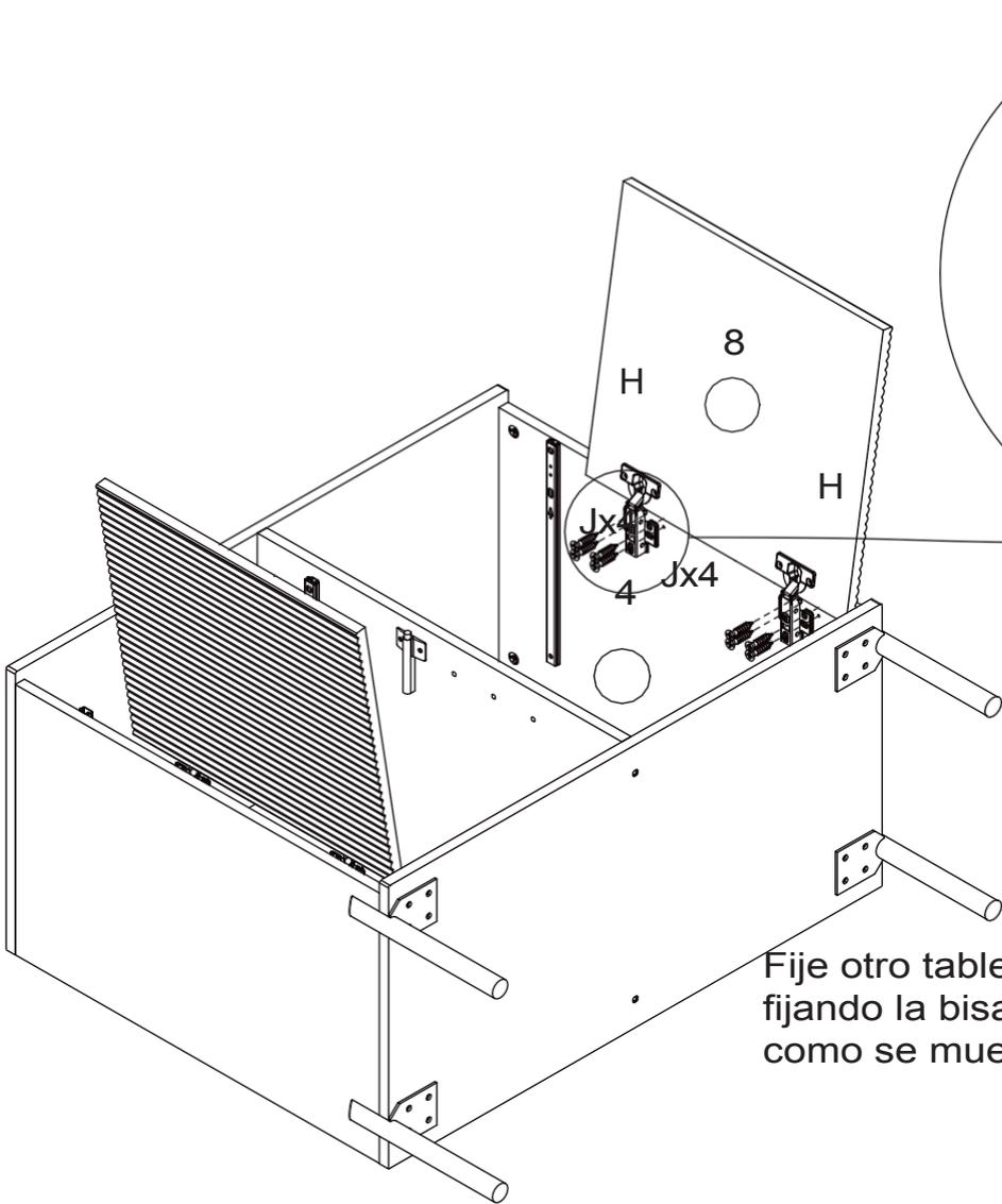
Fije otro tablero 8 al tablero 4 fijando la bisagra con el tornillo(J) como se muestra.
