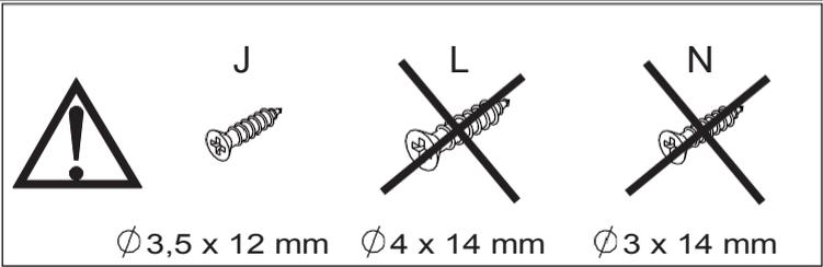
Fije el riel de deslizamiento (O1) a la placa 3 con el tornillo (J) como se muestra.
