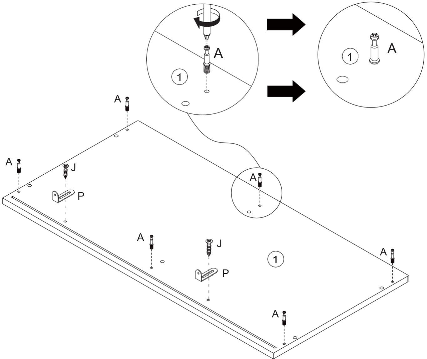
Atornille la varilla excéntrica(A) en la placa 1. Fije la pieza(P) a la placa 1 con el tornillo(J).
