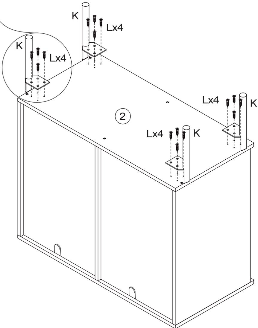
Fije la pata(K) al tablero 2 con el tornillo(L) como se muestra.
