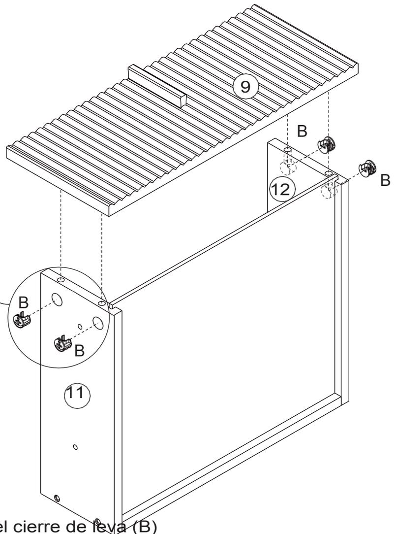
Fije la placa 9 al cajón, añada el cierre de leva (B) en los orificios de la placa 11,12 y gírelo en el sentido de las agujas del reloj para apretarlo como se muestra.
