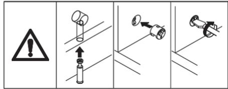
Fije las tablas 3, 5 y 4 a la tabla 1 con tacos de madera (C) al principio. Añada el cierre de leva (B) en los orificios de la placa 3,5,4 y gírelo en el sentido de las agujas del reloj para apretarlo como se muestra.
