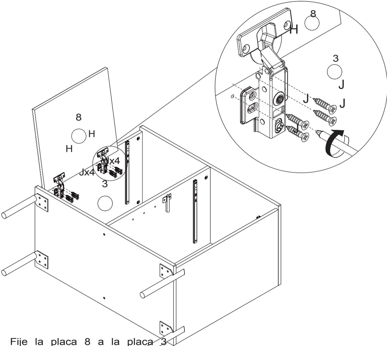
Fije la placa 8 a la placa 3 fijando la bisagra con el tornillo(J) como se muestra.
