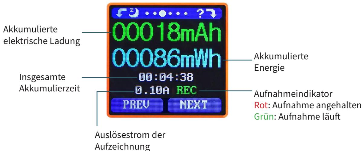
Nach dem Einschalten beginnt das System, wenn der fließende Strom größer als der Auslösewert ist, automatisch mit der Aufzeichnung der akkumulierten elektrischen Ladung, Energie und der verstrichenen Zeit. Die Anzeige „REC“ wechselt daraufhin von rot zu grün.
