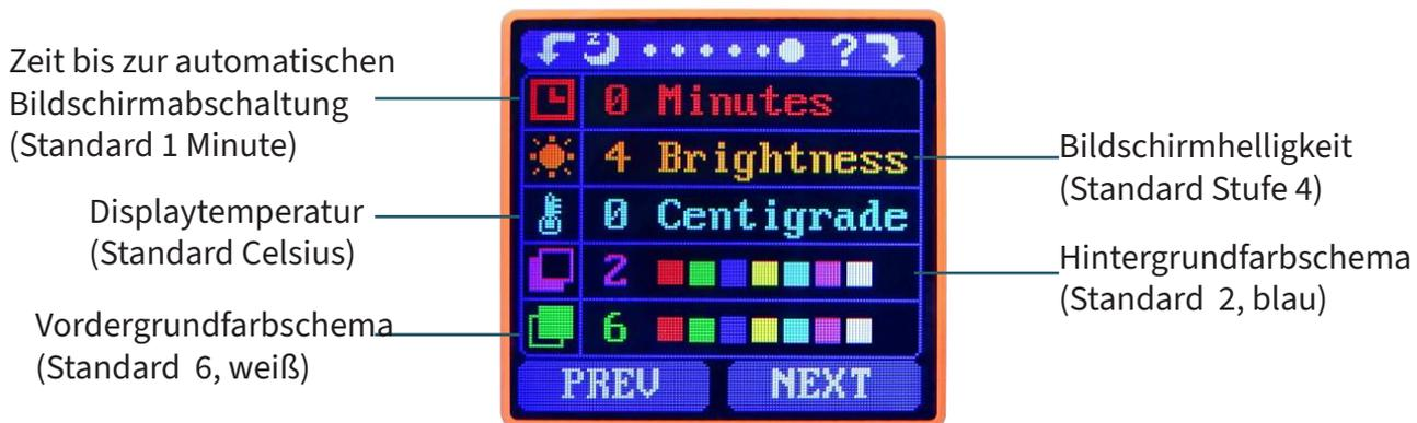
Halten Sie die Taste **NEXT** gedrückt, um in den Einstellmodus zu gelangen, drücken Sie die Taste **NEXT** erneut, um durch die einzelnen Optionen zu navigieren. Drücken Sie dann die Taste **PREV** um eine entsprechende Einstellung zu ändern und erneut **PREV** um die einzelnen Einstellmöglichkeiten zu durchlaufen. Halten Sie bei jedem Einstellzustand die Taste **NEXT** gedrückt, um das Einstellungsmenü zu verlassen.
