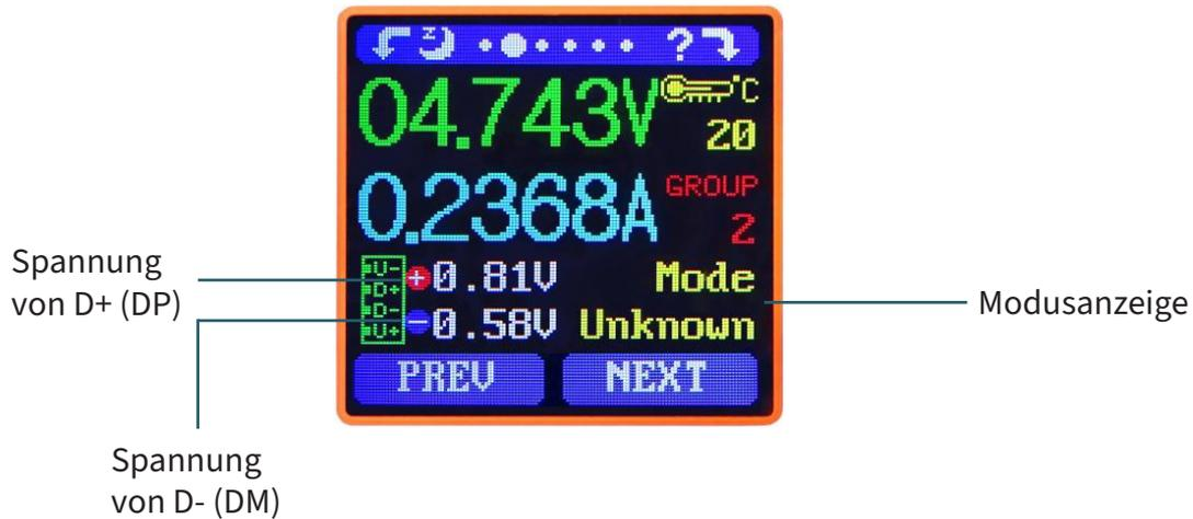
Das Messgerät erkennt automatisch Geräte mit QuickCharge-Unterstützung. Folgende Quickcharge-Modi werden derzeit unterstützt:
