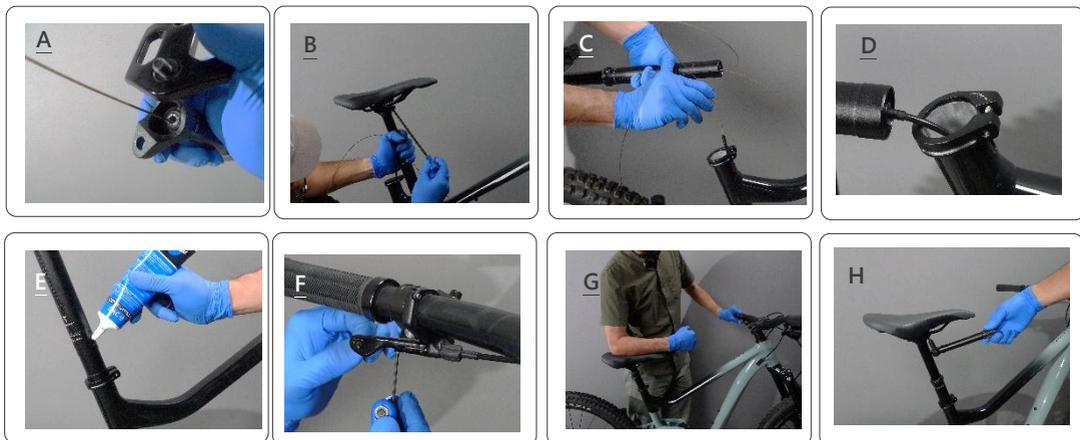
1. (Ve el Paso 2 si estás montando una bicicleta nueva) Desmonta el sillín y la tija del sillín y el sillín de la bicicleta antes de instalar GIANT CONTACT SWITCH SL.
