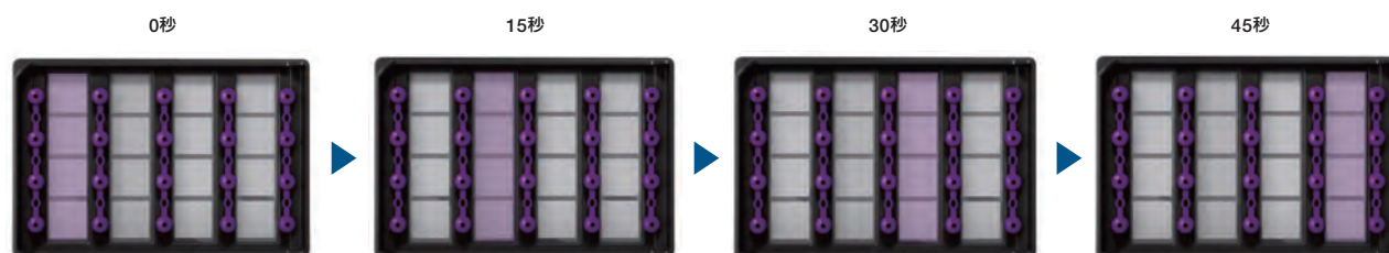
図1 消耗品であるMAP16プレートを1実験ごとに1列ずつ4回使用して、FAM/HEXマルチプレックスアッセイのアニーリング/伸長時間を最適化しました。
