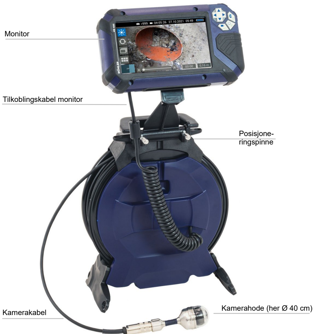
Fig. 53: Kabeltrommel med tilkoblet monitor og kamerahode
