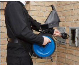
Abb. 12: Kabeltrommelkamera mit Tragegurt getragen
