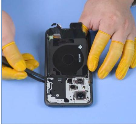
4. Utilice las pinzas de plástico para sacar la subplaca flash de la abertura de extracción.
