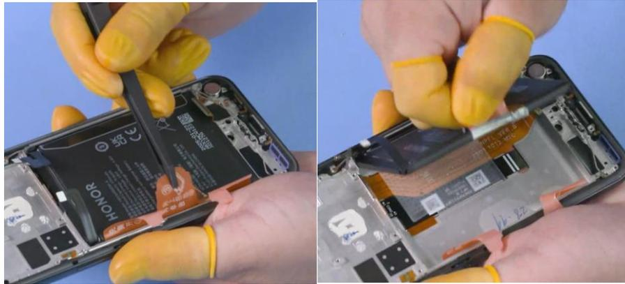
4. Elimine el adhesivo de la batería; utilice el borrador de adhesivo para eliminar el adhesivo residual; verifique que la superficie del compartimiento de la batería esté libre de objetos extraños.
