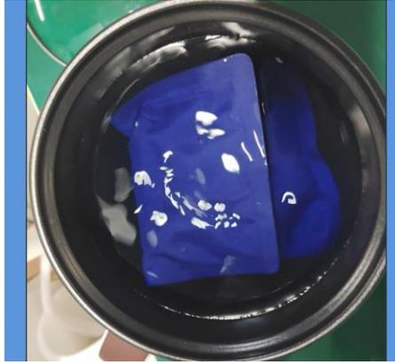
2. Caliente la cubierta trasera con la bolsa de calentamiento a 60 °C - 70 °C entre 3 y 5 minutos.
