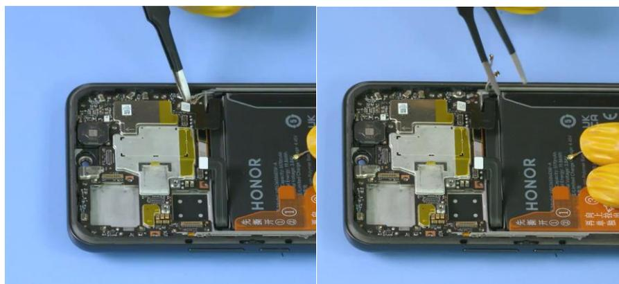
2. Use la punta de destornillador Phillips para retirar los 2 tornillos M1,2 de la PCBA.
