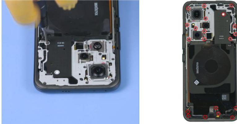
2. Quite el adhesivo de la bobina de carga inalámbrica y del extremo de la lámina de grafito.
