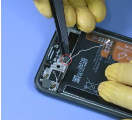
2. Retire el adhesivo residual del sensor de huellas digitales.
