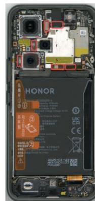
4. Retire todas las cámaras, retire los soportes de las cámaras.
