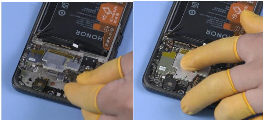
2. Utilice el destornillador para ajustar los dos tornillos de prefijación M1,2 a la PCBA.
