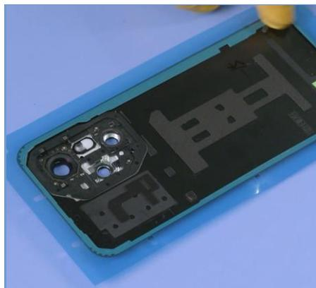
2. Presione los cuatro lados de la cubierta trasera con las yemas de los dedos para activar el adhesivo.
