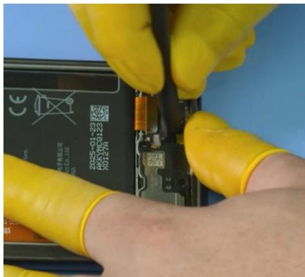
3. Desconecte los conectores del cable coaxial de la subplaca auxiliar y extraiga lentamente los cables coaxiales de la ranura del cable.
