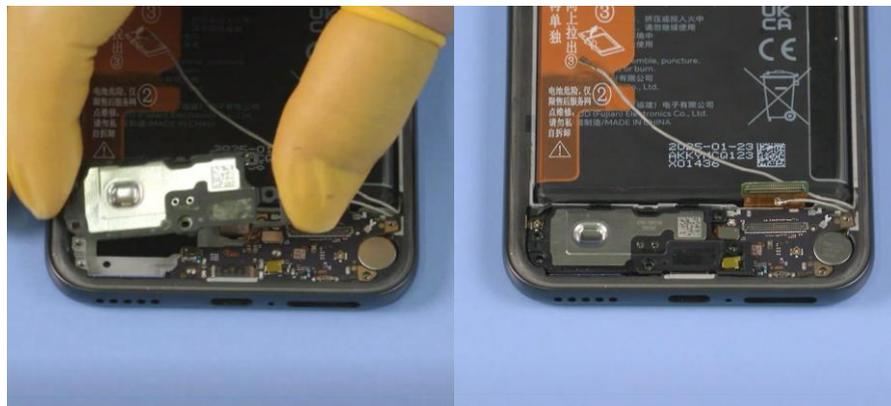
4. Fije el cable coaxial en el lateral de la placa secundaria; conecte el cable coaxial largo al enchufe hembra de la placa auxiliar; introduzca el cable coaxial largo en su ranura.
