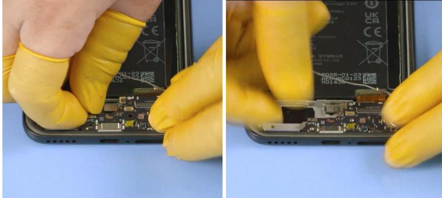
2. Use la punta de destornillador Phillips para apretar 1 tornillos M1,2.
