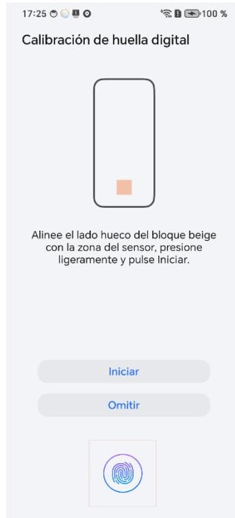
4. Siga las instrucciones en pantalla y no mueva el dispositivo ni el bloque de calibración beige. Mantenga presionado durante 15 segundos. Una vez completada la calibración, se muestra la siguiente pantalla de calibración.
