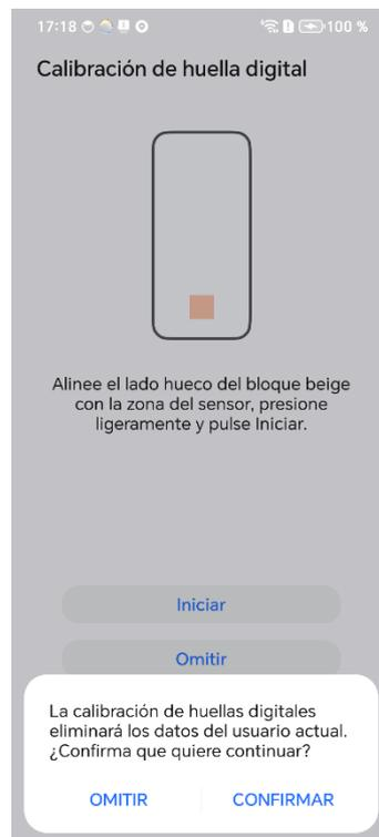
3. Siga las instrucciones en pantalla para alinear el bloque de calibración beige, presione ligeramente en el área designada y toque **Iniciar**. Si toca **Saltar**, la calibración finalizará.
