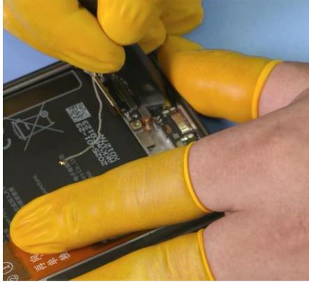
3. Utilice las pinzas metálicas de punta plana para inclinar hacia arriba la subplaca USB desde la abertura de extracción y, una vez que está elevada, retire la subplaca.
