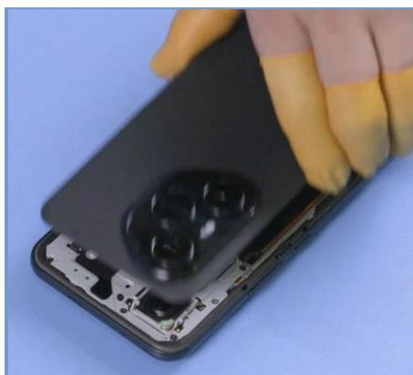
6. Presione los cuatro lados de la cubierta trasera con las manos para activar el adhesivo.
