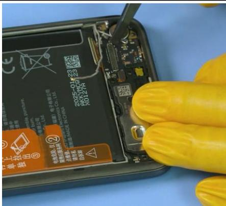
4. Utilice las pinzas metálicas de punta plana para sacar el altavoz de la abertura de extracción. Retire el altavoz.
