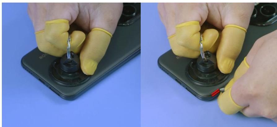
4. Inserte la púa de apertura y corte el adhesivo en ambos lados. Use la púa de apertura para cortar lentamente el adhesivo en la parte superior de la cubierta trasera.
