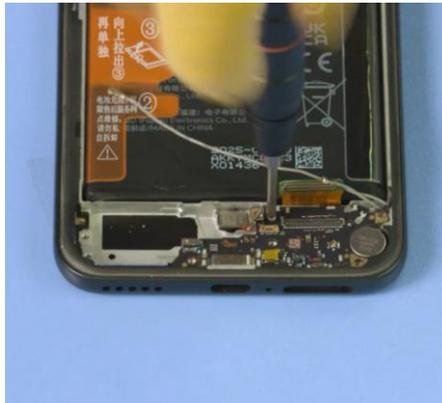
3. Fije el conector FPC BTB del sensor de huellas digitales.
