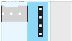
L'accessoire Output OC s'insère dans le logement Relay de la commande de plafond, voir la notice séparée de "Output OC".
