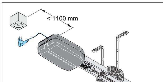
Le câble secteur mesure env. 1,2 m. Le câble d'alimentation électrique fourni ne doit être ni raccourci ni rallongé. Respectez une distance de 1,1 m maximum entre la commande de plafond et la prise électrique.
