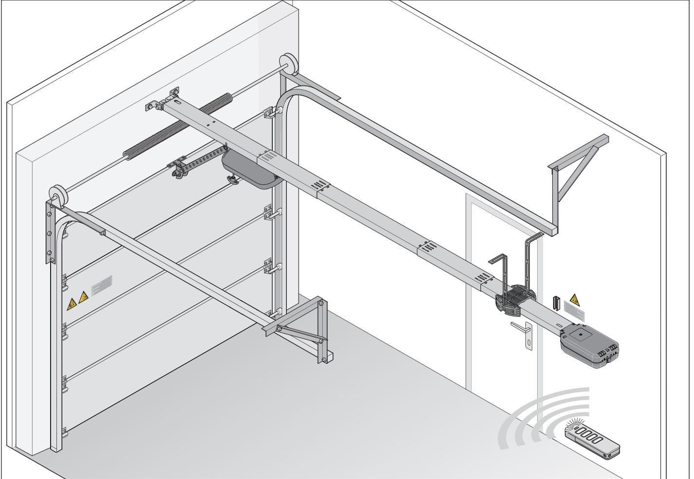
L'automatisme électrique et les accessoires fournis permettent d'ouvrir et de fermer les portes sectionnelles et d'autres types de portes. L'automatisme se commande par exemple avec un émetteur portable.
