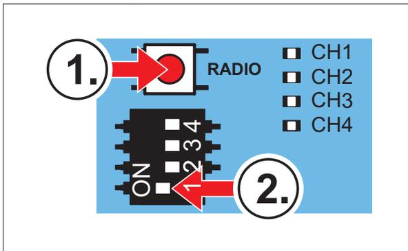
3. Commencer par **appuyer et maintenir enfoncée** la touche RADIO. Pendant ce temps, régler l'interrupteur DIP 1 sur ON.
