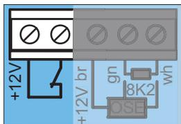
La sécurité de portillon empêche l'utilisation de la porte lorsque le portillon est ouvert. La sécurité de portillon de SOMMER est conforme aux exigences de la norme EN 12453 (Plc). Installez uniquement la sécurité de portillon de SOMMER, réf. S11474-0001.
