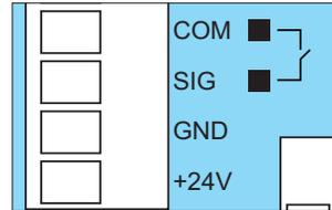
Borne de raccordement pour barrière lumineuse 4 fils
