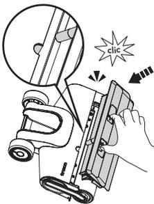
Cuando sustituya la cubierta, fíjela siempre en su posición para evitar fugas.
