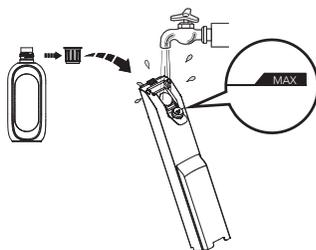
Abra el tapón del depósito y llénelo con agua del grifo hasta la línea de nivel máximo. Cuando sea necesario realizar una limpieza a fondo, añada un tapón de solución al DAL y cierre bien el tapón.
