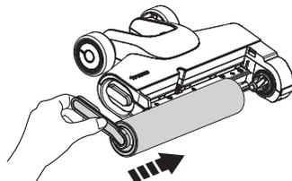
Para volver a colocar el cepillo de rodillo, inserte el extremo del cepillo de rodillo en el lado derecho del soporte y, a continuación, acople la pestaña del rodillo a la hebilla magnética del lado izquierdo para bloquearla.
