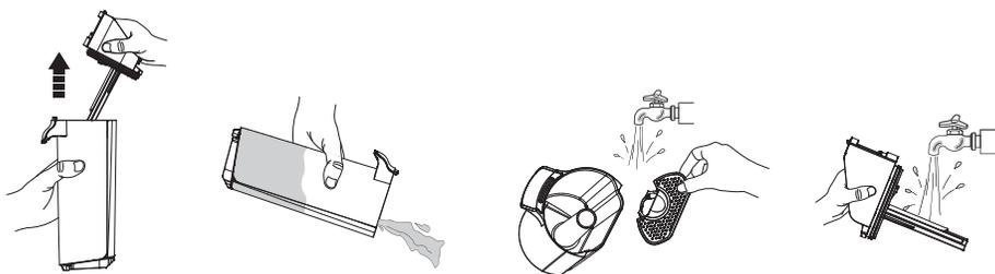
Si la tapa del depósito de agua sucia y el filtro interior están bloqueados, retire la tapa del depósito y el filtro y enjuague ambas partes con agua.
