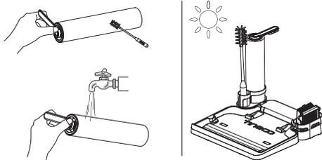
Con la herramienta de limpieza, elimine el pelo y los residuos que hayan quedado enrollados en el rodillo y enjuáguelo con agua. Vuelva a colocar el cepillo de rodillo en el soporte de accesorios y deje que se seque completamente antes de volver a instalarlo.
