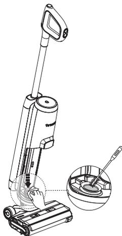
Retire el depósito de agua sucia, limpie el puerto de agua sucia con un paño húmedo o con la herramienta de limpieza para evitar obstrucciones.
