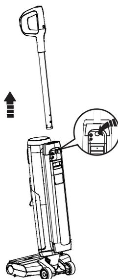
En caso de que necesite desmontar el asa, pulse el botón de desbloqueo situado en la parte posterior del aparato y, a continuación, tire del asa hacia arriba.
