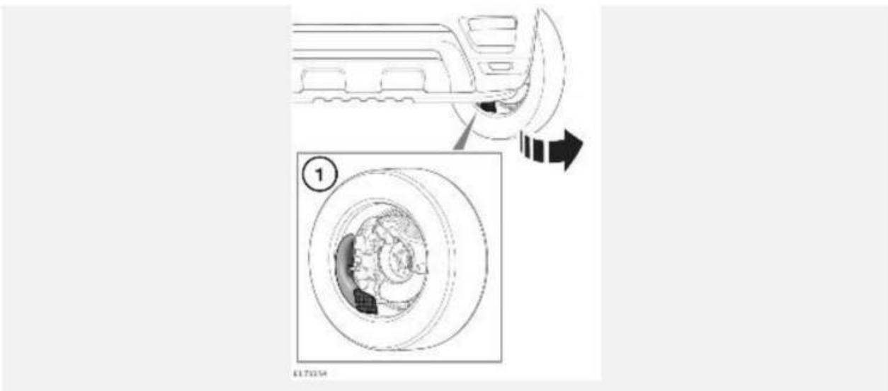
Передние колеса автомобилей SVR оснащены вентиляционными каналами тормоза. После езды по бездорожью обращайте особое внимание на данные участки. Проверьте вентиляционный канал (1) на предмет загрязнений. При необходимости можно использовать мойку под давлением.
