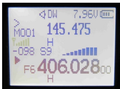
Photo 2 : Afficheur du TX UV-K5 avec S-mètre
