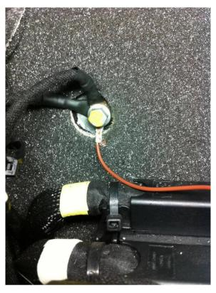
3 · FIND YELLOW/BLACK CABLE LINES FROM ELECTRONIC POWER CONTROL ON THE RIGHT HAND SIDE OF ACCELERATOR PEDAL, THEN CONNECT YELLOW/BLACK CABLES
