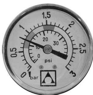
0,8 kg/cm 2 - 11,4 PSI: Pressão normal ao realizar o ciclo de filtração.
