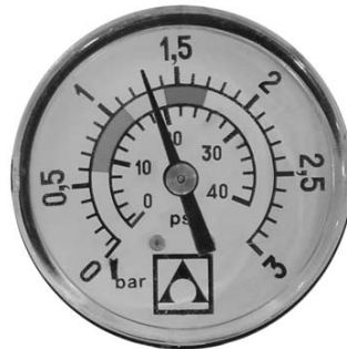
1,3 \text{ kg/cm}^2 - 18,5 PSI: Dieser Druck zeigt an, dass ein "SPÜLEN" notwendig ist.
