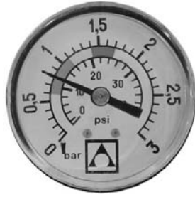
0,8 kg/cm 2 - 11,4 PSI: filitreleme sürecinin başındaki normal basınç
