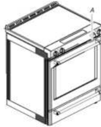
A. Placa que indica modelo/serie/valores nominales (detrás de la puerta del horno, en la parte superior del lado derecho del marco del horno)
