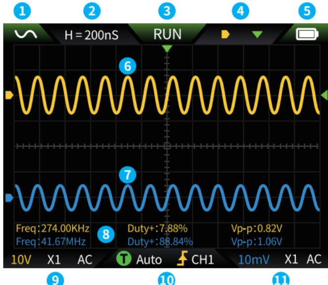
① Индикация функций генератора сигналов: 13 типов форм: Синусодальная волна , Квадратная волна , Пилообразная волна , Полуволна , Полная волна , Ступенчатая волна , Обратная ступенчатая волна , Экспоненциальный подъем , Экспоненциальный спад , Постоянный ток , Мультизвуковой сигнала , Понижающий импульс , Волна Лоренца . Серый цвет указывает, что сигнал отключен.
