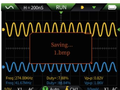
② **Просмотр сохраненных изображений:** Длительное нажатие кнопки **SAVE** позволяет перейти на страницу просмотра сохраненной формы сигнала. Нажмите **||▶**, чтобы перейти к интерфейсу сохраненной формы сигнала.
