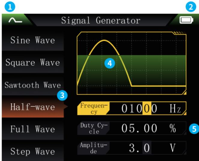
①Индикация выходного сигнала: доступно 13 видов сигнала, подробное описание находится в разделе 1.2
