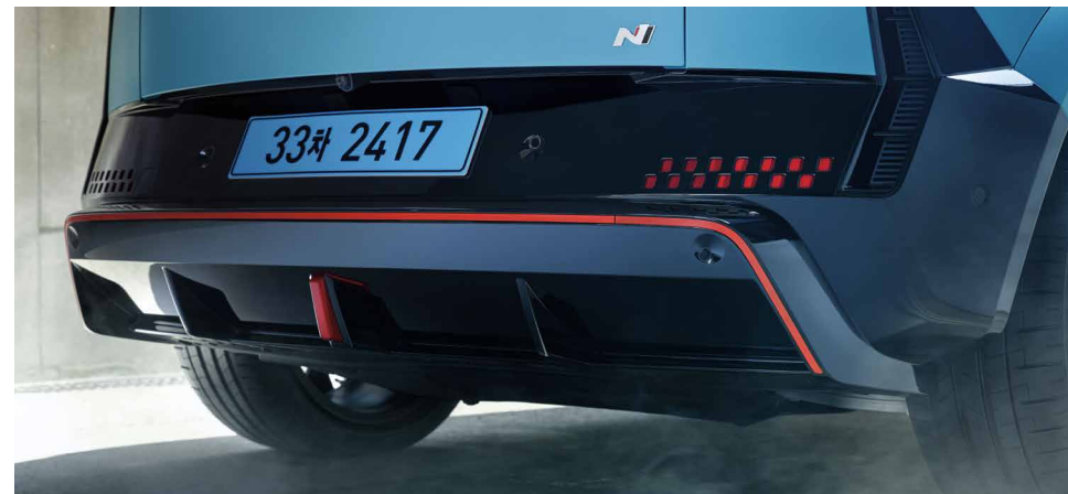
아이오닉 5 N 전용 21인치 단조 휠 & 피렐리 P-Zero 썸머 타이어(275/35ZR/21), N 휠캡 포함 N 전용 리어 범퍼 및 디퓨저
