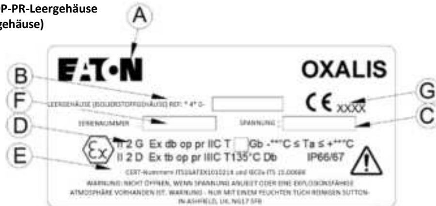
**5.3 Etikett für OP-IS-Leergehäuse (Isolierstoffgehäuse)**
