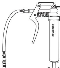
À l'extrémité du tuyau flexible, fixé avec un coupleur à 4 mâchoires.
