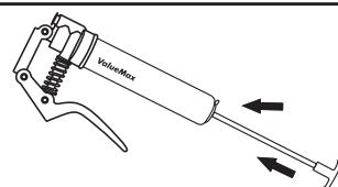
Agarre la empuñadura en T y tire ligeramente hacia atrás, luego mantenga presionado el bloqueo de la varilla para soltarla. Empuje el mango en T de la varilla del émbolo para introducirlo en el cartucho.
