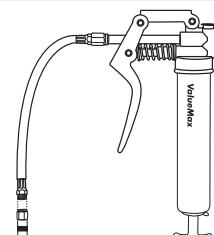
En el extremo de la manguera flexible, fijada con un acoplador de 4 mordazas.
