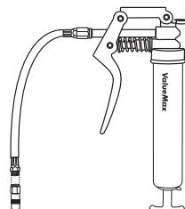
Am Ende des flexiblen Schlauches, befestigt mit 4-Backen-Kupplung.
