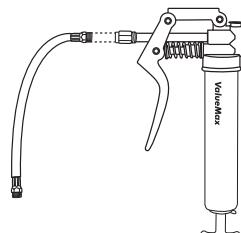
Fixer le tuyau flexible aux filetages de la buse.
