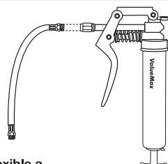
Conecte la manguera flexible a las roscas de la boquilla.
