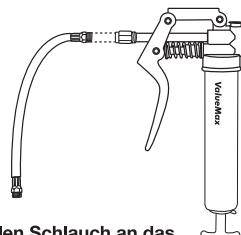
Schließen Sie den flexiblen Schlauch an das Gewinde der Düse an.
