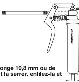
Sélectionner la rallonge 10,8 mm ou de 14,6 mm, l'enfiler et la serrer. enfilez-la et serrez-la.
