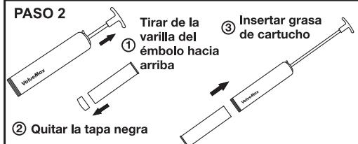
⚠ PRECAUCIÓN: Asegúrese de tirar de la varilla del émbolo hasta el final, la varilla del émbolo se bloqueará!
