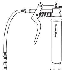
All'estremità del tubo flessibile, fissato con accoppiatore a 4 ganasce.
