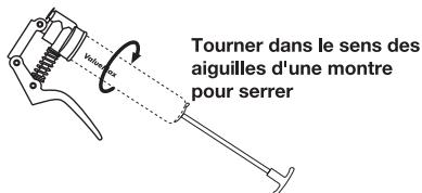
⚠ ATTENTION : décollez le couvercle en aluminium avant de serrer. Avant de serrer la tête du pistolet à graisse, n'appuyez jamais sur le verrou, sinon de la graisse pourrait pulvériser !
