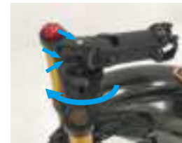
1. Stellen Sie oben und links und rechts Schrauben zum Drehen der verstellbaren Steigen Sie 180 Grad und sichern Sie es in Ort
