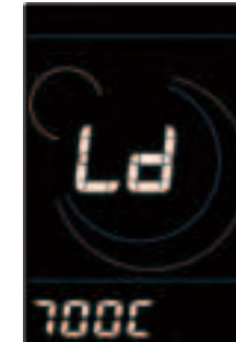
Schnittstelle zur Einstellung des Raddurchmessers
