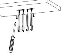
INSTALL THE POWER UNDERCARRIAGE EQUALLY DISTANCE AROUND THE USB UNIT CUTOUT USING THE CORRECT LENGTH SELF TAPPING SCREWS
