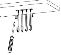
INSTALL THE POWER UNDERCARRIAGE EQUALLY DISTANCE AROUND THE USB UNIT CUTOUT USING THE CORRECT LENGTH SELF TAPPING SCREWS
