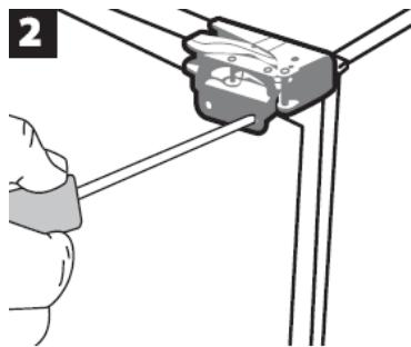
Entfernen Sie bei geschlossener Tür die äußeren Scharnierschrauben.
