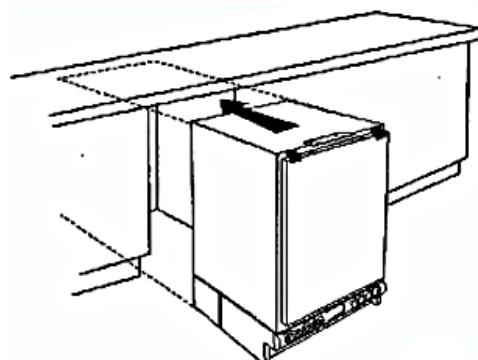
d. Befestigung unter einer Arbeitsplatte
