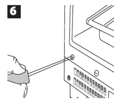
Entfernen Sie die Verschlussstreifen unten am Gerät.
