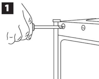
Entfernen Sie die Verschlussstreifen der Gerätetür.
