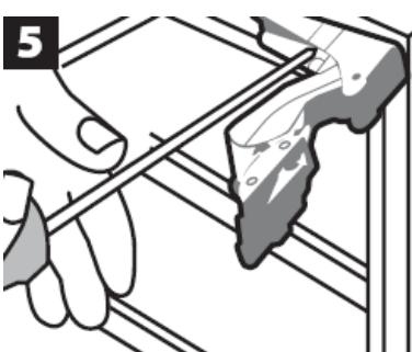
Entfernen Sie bei geöffnetem Scharnier die Schrauben des oberen Scharniers.
