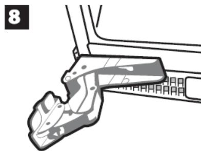
Wiederholen Sie den Vorgang mit dem anderen Scharnier. Befestigen Sie die Verschlussstreifen. Befestigen Sie die Tür.
