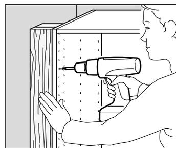
Per assicurarti che il riempitivo resti in posizione, applica prima una barra di supporto alla parete. Pratica i fori nel mobile per le viti necessarie a unirlo al riempitivo. Posiziona il riempitivo. Inserisci le viti nei fori praticati. Una volta posizionati tutti i riempitivi, sigillali con il silicone per assicurarne la tenuta ermetica.
