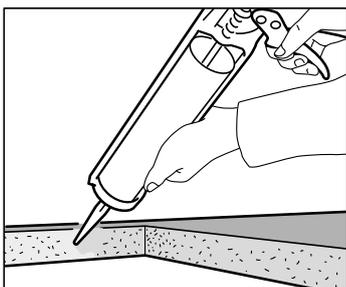
Per evitare che l'umidità penetri nel piano di lavoro, applica del silicone poliuretano lungo i bordi tagliati.
