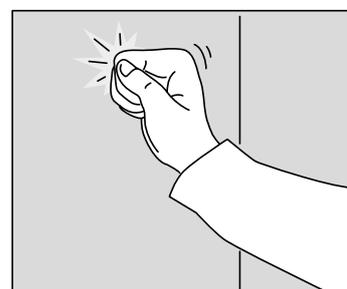
Controlla che le pareti siano abbastanza resistenti da reggere i binari di sospensione e i pensili. A seconda del materiale della parete, si consiglia di installare il binario su un montante o una trave portante. Può esserti utile un rilevatore elettronico di metalli e cavi elettrici.
