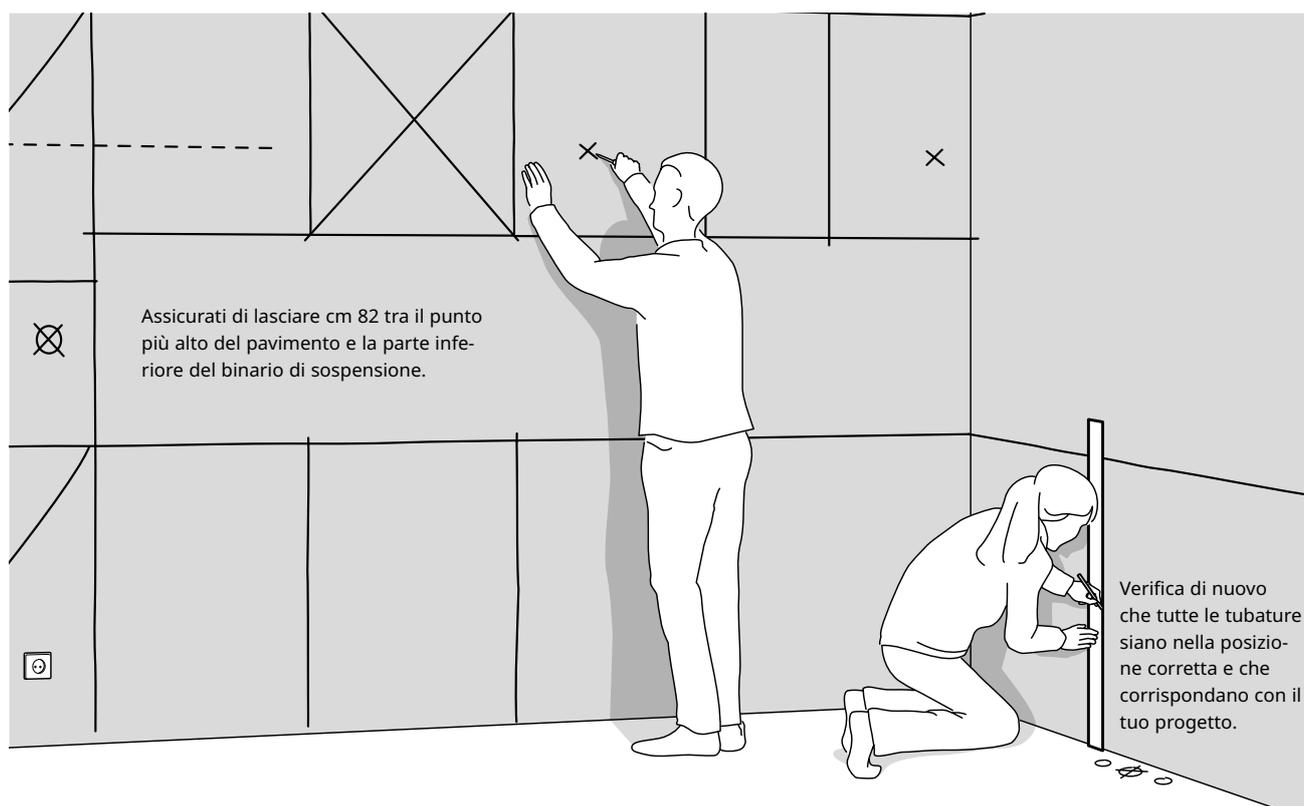
Assicurati di lasciare cm 82 tra il punto più alto del pavimento e la parte inferiore del binario di sospensione.
