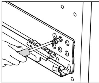
Una volta fissate le guide dei cassetti esterni, procedi fissando quelle per i cassetti interni. Le guide dei cassetti interni devono essere montate sulla fila di fori più interna.
