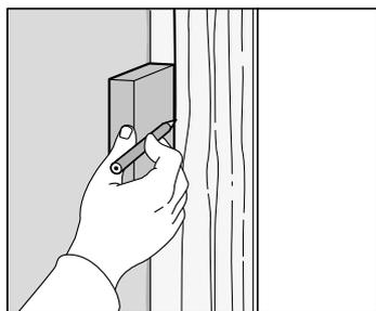
Se la parete non è perfettamente dritta e regolare, devi tagliare il riempitivo in modo da seguire la forma della parete. Per farlo, hai bisogno di un riempitivo, un metro a nastro, un blocchetto di legno dello spessore di cm 2,5-3,5 e di una matita.
