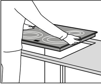
Procedi allo stesso modo per l'inserimento del piano cottura come hai fatto per il livello. Segui le istruzioni di montaggio del piano cottura.
