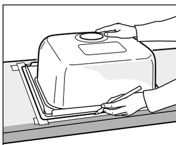
Posiziona il piano di lavoro nella sua sede e segna il punto in cui devi installare il lavello. Traccia il profilo interno del mobile base sul lato inferiore del piano di lavoro. Questo ti aiuterà ad allineare correttamente il lavello. Capovolgi il piano di lavoro e traccia il contorno del lavello sopra il nastro adesivo.
