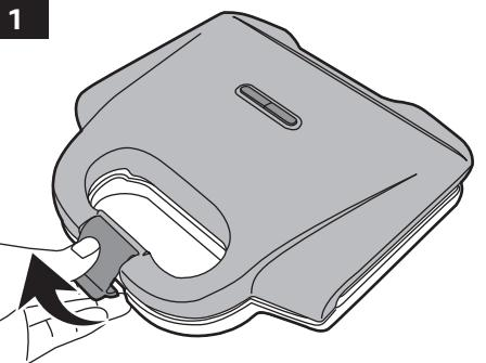
3. Déverrouillez l'appareil en ouvrant le loquet (G) (ill. 1).
