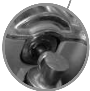
Position du moteur verrouillé : Le téton doit être en position ressortie
