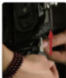
3. Stecken Sie den Schlüssel in die Akku Verriegelung
