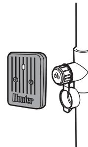
1. Installez un "T" à filetage femelle de 13 mm dans le conduit de câblage de campagne à environ 30 cm au-dessous du Pro-C.
