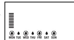
Après la programmation, réglez le cadran à **ARROSAGE (RUN)** pour valider l'exécution automatique de tous les programmes et heures de départ sélectionnés.
