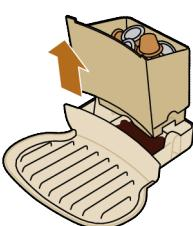
**Atenção:** tenha cuidado ao remover o compartimento de cápsulas usadas. As cápsulas permanecem quentes imediatamente após o processo de preparação do café.
