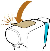
**Warnhinweis: Fassen Sie beim Schließen des Hebels nicht mit dem Finger in die Brühkammer, um Verletzungen zu vermeiden. An der Innenseite des Hebels befindet sich ein unsichtbarer, spitzer Dorn.**
