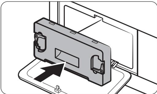
5. Vuelva a insertar la cubierta interior en su posición original y a continuación bloquee las fijaciones.
