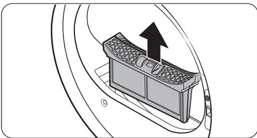
1. Abra la puerta de la secadora, agarre la parte superior del filtro de pelusa y tire para retirar el filtro.
