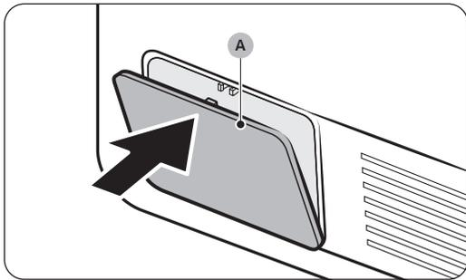
1. Presione suavemente la parte superior de la **cubierta exterior (A)** para abrirla.
