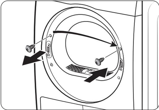
5. Quite el tornillo superior de la izquierda del marco de la puerta e insértelo en el orificio correspondiente de la derecha del marco de la puerta. No quite los tornillos de la abrazadera inferior.
