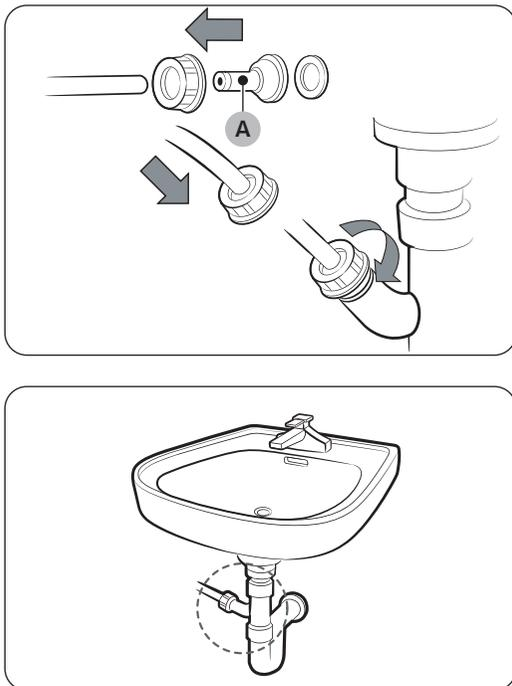
1. Instale el **conector de la manguera (A)** y fíjelo al extremo de la manguera accesoria como se muestra.
