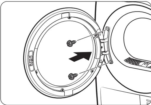
10. Inserte la bisagra de la puerta en el lado opuesto del marco de la puerta y ajuste los 2 tornillos.
