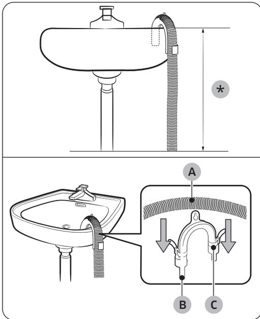
1. Asegúrese de colocar el extremo de la manguera accesoria a menos de **90 cm (\*)** de la parte inferior de la secadora.
