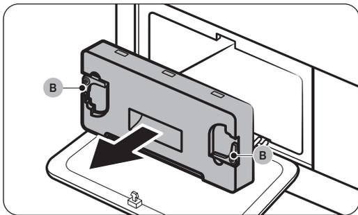
2. Desbloquee los **fijadores (B)** de la cubierta interior y después tire de la cubierta interior para sacarlo.
