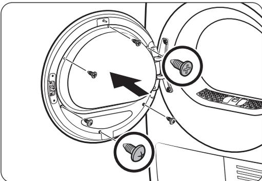
12. Apriete los 3 tornillos del soporte de la parte superior. A continuación, apriete los 3 tornillos del soporte de la parte inferior.
