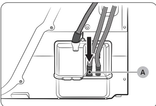
2. Inserte un extremo de la manguera accesoria (la manguera de desagüe larga) en el **orificio (A)**.
