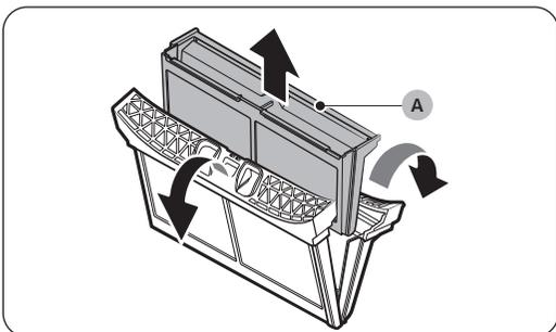
2. Abra el filtro exterior y retire el **filtro interior (A)**.
