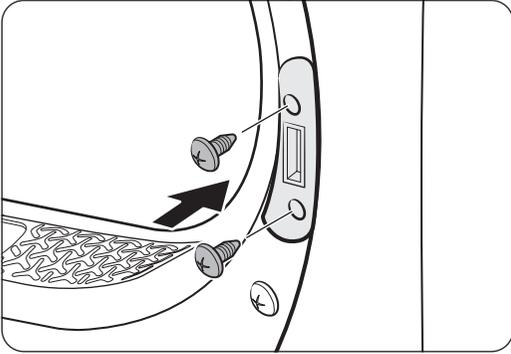
9. Inserte el soporte de la palanca en el marco derecho y ajuste los 2 tornillos del soporte.
