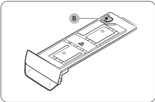
1. Retire el **depósito de agua (A)** de la secadora.
