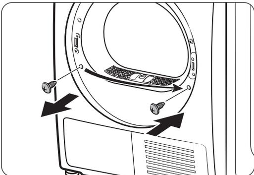
8. Quite el tornillo inferior de la izquierda del marco izquierdo e insértelo en el orificio correspondiente del marco derecho.
