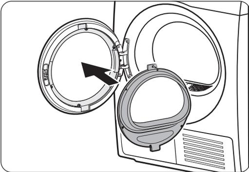
11. Inserte el soporte del cristal interior en el aro de la puerta que se ha instalado en el marco izquierdo.
