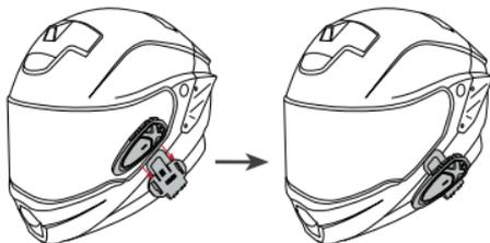
Étape 2 : Poussez vers le bas jusqu'à ce que les languettes situées en haut de l'arrière de l'unité centrale GTX entrent dans les trous carrés de la support, pour que l'installation soit terminée.
