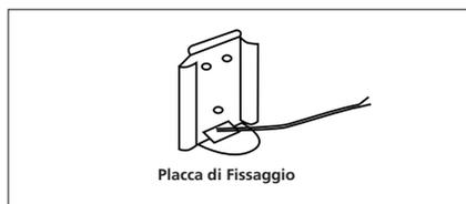
Montate la placca di fissaggio della staffa a parete sul muro, nella posizione desiderata.
