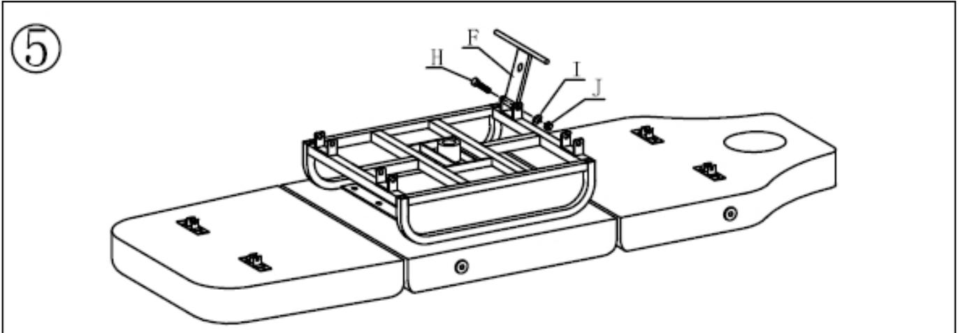
5. Montieren Sie das Element F, indem Sie es mit den Elementen I, J und H festziehen.
