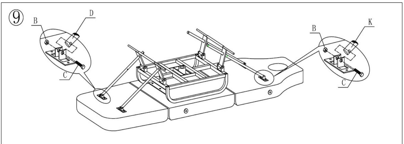
9. Setzen Sie die Teile D und K ein und verschrauben Sie sie mit B und C.
