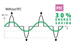
PFC tehnoloģija slāpē sprieguma maksimumus un regulē barošanas strāvu. Tā arī ļauj iekārtai darboties, izmantojot pagarinātājus vai akumulatora barošanas avotu, kā arī nodrošina labāku strāvas stabilitāti metināšanas posmā.
