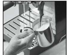
7. Immergez la buse vapeur dans le lait de sorte que son extrémité se trouve à environ un demi-pouce (1,25 cm) sous la surface et mettez le commutateur Vapeur/eau chaude à la position vapeur.
