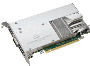
**Intel® PAC with Intel® Arria® 10 GX FPGA** 以一种低功耗，小巧外形尺寸来提供 FPGA 加速，并对高达 40 Gbps 的速度提供内联加速。它的性能和多功能性使您能够在数据中心和企业应用加速中实施各种解决方案。
