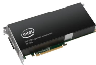
**Intel® FPGA PAC D5005** 提供一个具有高达 100 Gbps 高速接口的高密度 Intel Stratix 10 FPGA，用于各种数据中心和企业应用的旁路 (look aside) 和内联 (inline) 加速—数据分析，AI，数据包监控，等等。
