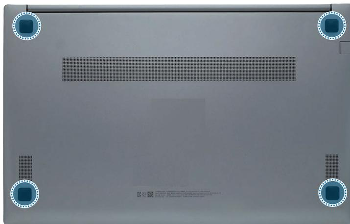
2 Con un destornillador de estrella, retire los 4 tornillos de la parte posterior del chasis.
