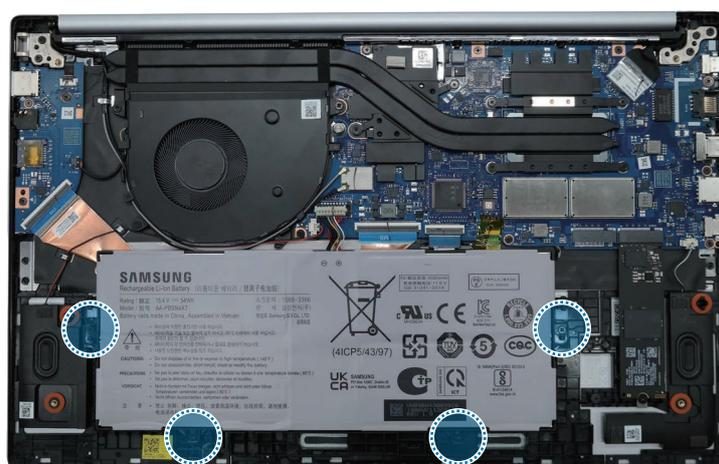
2 Coloque el conector de la batería y presiónelo hasta que haga clic.
