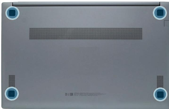
3 Alinee las 4 patas de goma con los orificios posteriores del chasis y presiónelas para fijarlas.
