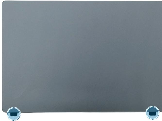
2 Coloque el panel táctil en la parte anterior del chasis.
