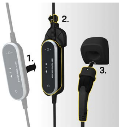
図7：コントロールユニットの取り付け
