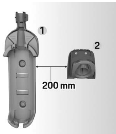
그림 2: 벽걸이 장착 장치에서 커넥터 잠금 장치까지의 거리
