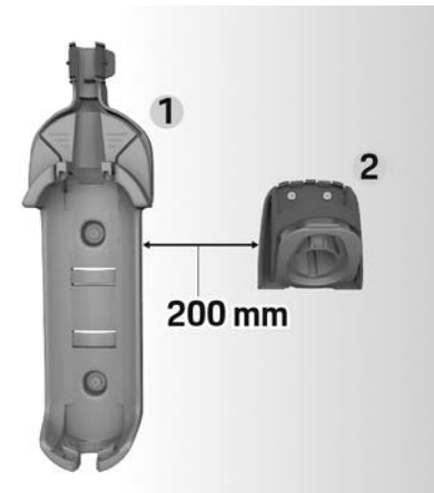
الشكل 2: المسافة من قاعدة التركيب الحائطية إلى مثبت الموصل
