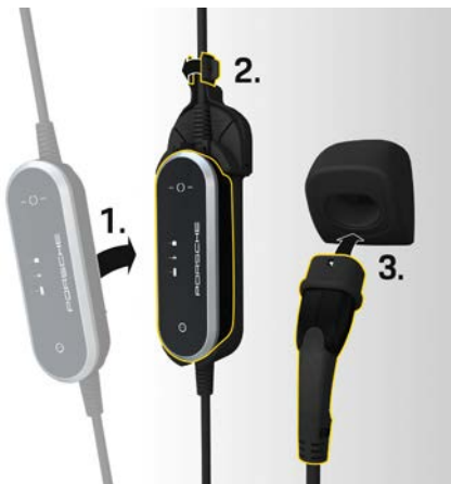
الشكل 7: تركيب وحدة التحكم
