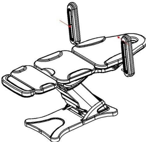
1. Manuelle Steuerungsfunktion (Hubhöhe: 58~ 82 cm vom Boden)
