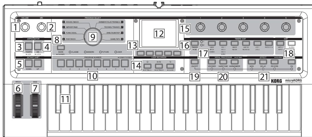
1 同时按下 VOCODER 按钮 **20** 和 ON/OFF 按钮 **19** 可打开/关闭声码器。
