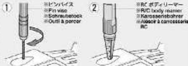
**〈ポリカーボネートボディの切り取り方〉 / Cutting out polycarbonate body parts**
