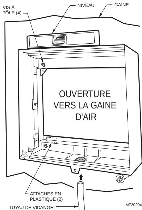
Fig. 5. Installation de l'humidificateur sur une gaine.
